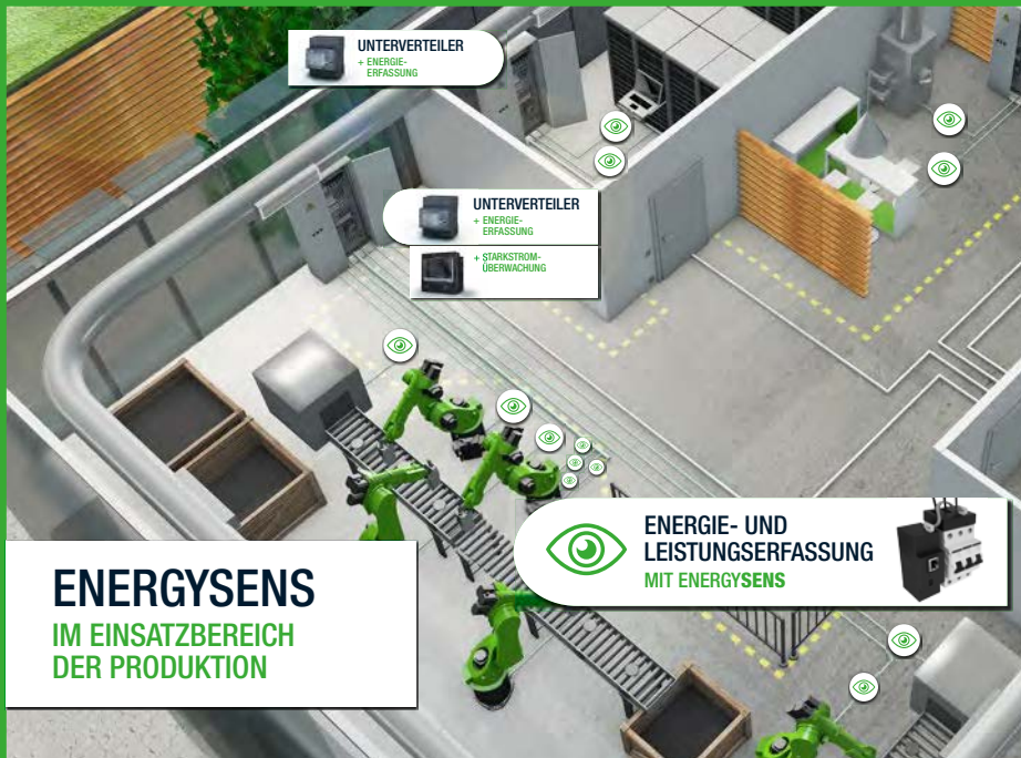
Überwachung der Phasenbelastung und Leistungserfassung von einzelnen Fertigungsmaschinen
